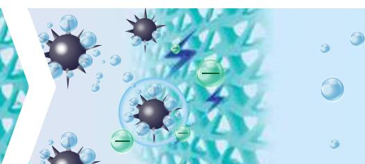
Bộ lọc bụi mịn hoạt động bằng lực hút tĩnh điện bằng cách tạo ra các ion âm (-) để giữ lại những hạt bụi siêu nhỏ chỉ 0.3 µm (micromet).
