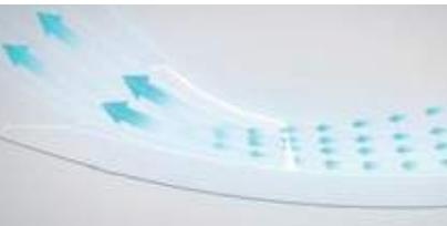
Phù hợp với nguyên lý của hiệu ứng ống hẹp, ống giãn nở tối ưu cho hẹp lại bên trong và rộng ra bên ngoài. Hiệu ứng "Venturi" xảy ra khi luồng không khí thổi qua ống dẫn ở giữa, giống như lũ tràn ra khỏi một con đập. Luồng không khí đi ra với tốc độ cao hơn nhiều.
