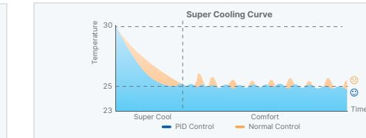
PID hoặc Proportion Integration Differentiation, điều khiển tối đa biến tần làm việc trước khi đạt đến nhiệt độ mong muốn và sau đó liên tục điều chỉnh thời gian thực tế để phù hợp nhiệt độ không khí trong phòng với nhiệt độ mong muốn.
