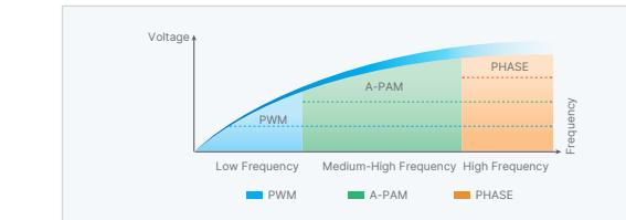
Triple Linkage Frequency Modulation hoặc TLFM tận dụng 3 cách điều khiển điện áp khác nhau để quản lý hiệu suất hoạt động tối ưu ở mọi pha tần số.
