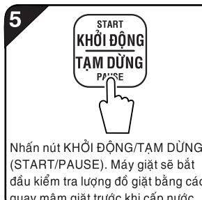
Nhấn nút KHỞI ĐỘNG/TẠM DỪNG (START/PAUSE). Máy giặt sẽ bắt đầu kiểm tra lượng đồ giặt bằng cách quay mâm giặt trước khi cấp nước.
