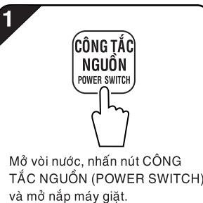
Mở vòi nước, nhấn nút CÔNG TẮC NGUỒN (POWER SWITCH) và mở nắp máy giặt.
