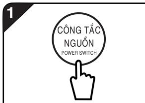
Mở vòi nước, nhấn nút CÔNG TẮC NGUỒN (POWER SWITCH) và mở nắp máy giặt.
