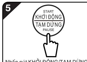
Nhấn nút KHỞI ĐỘNG/TẠM DỪNG (START/PAUSE). Máy giặt sẽ bắt đầu kiểm tra lượng đồ giặt bằng cách quay mâm giặt trước khi cấp nước.
