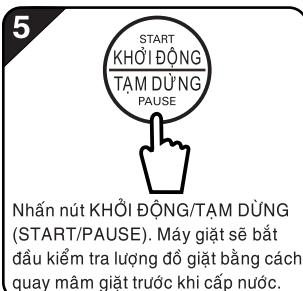
Nhấn nút KHỞI ĐỘNG/TẠM DỪNG (START/PAUSE). Máy giặt sẽ bắt đầu kiểm tra lượng đồ giặt bằng cách quay mâm giặt trước khi cấp nước.
